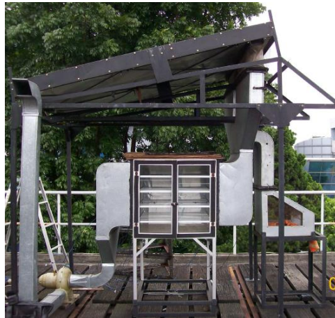
Gambar 2.5 Alat Pengering Surya Aktif Tidak Langsung (Sumber : Endri Yani, 2009)
