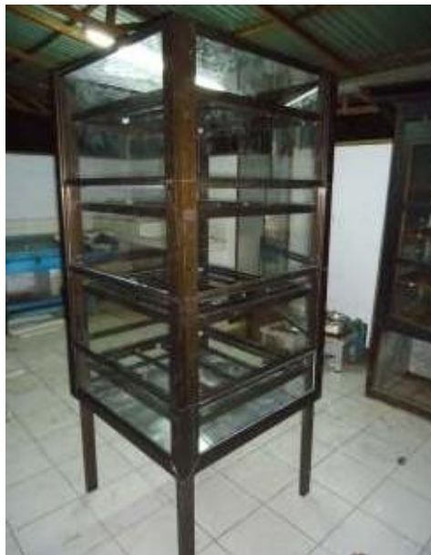
Gambar : 2.1 alat pengering ikan tenaga surya sistem bongkar pasang. (sumber : Youce, Jongky, dan Hens Onibala, 2013)
