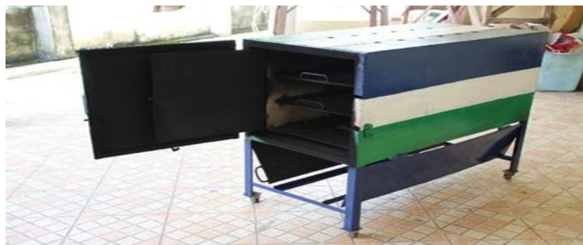
Gambar 2.2 Alat Pengering Ikan Dengan Memanfaatkan energi Briket Batu Bara ( sumber :Aneka Firdaus, 2016 )
