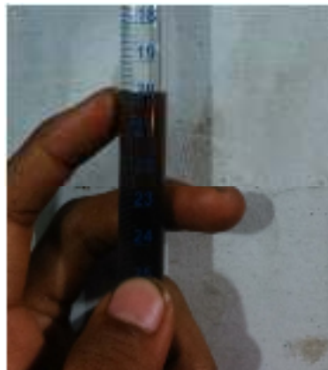
Gambar 3.11 Burette terisi campuran oli dan bensin titik 0 = 20 cc
