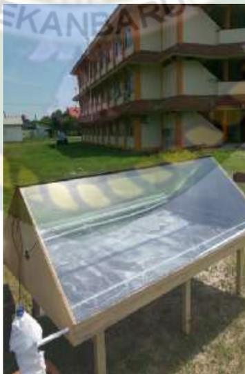
Gambar 2.2 Alat Destilasi Tenaga Surya Dengan Tipe Kaca Penutup Dua Kemiringan
