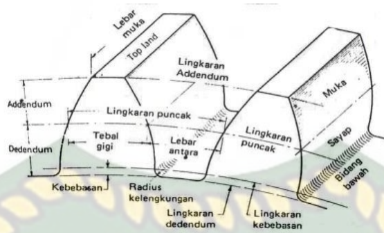
Gambar 2.14 bagian – bagian roda gigi
