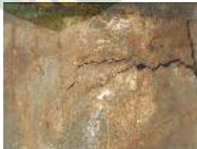
Gambar 2.7. Korosi Tegangan (*stress corrosion*)
