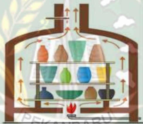
Gambar 2.10 Tungku api naik (up draft kiln)
