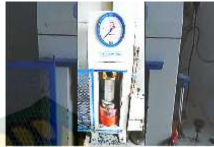
Gambar 3.3 Benda Uji dan Alat Tekan Compression Testing Machine , (Sumber: SNI 4431:2011).
