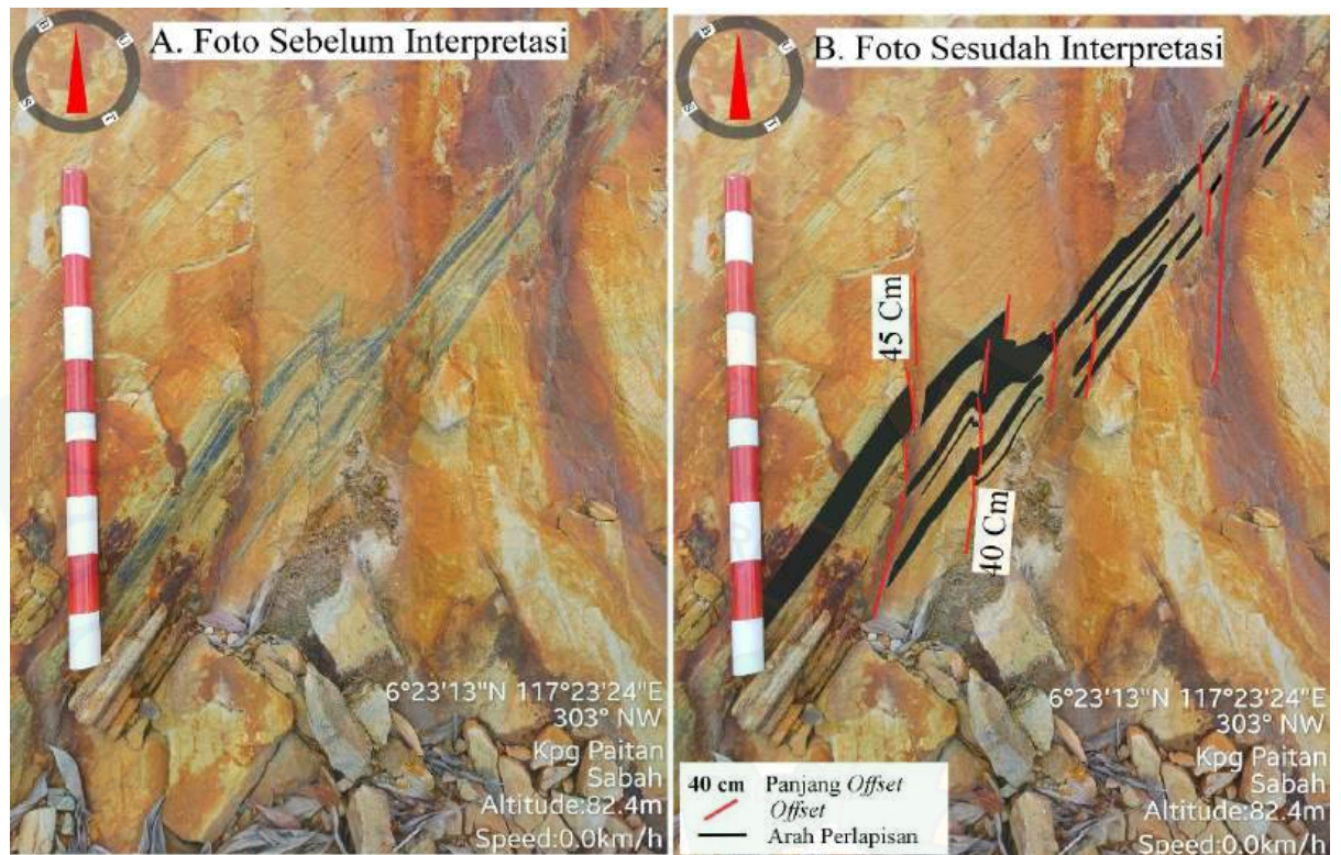
Gambar 4. 19 Foto Offset Pelapisan Pada Stasiun 1 (A) Foto Sebelum Interpretasi, (B) Foto Setelah Interpretasi
