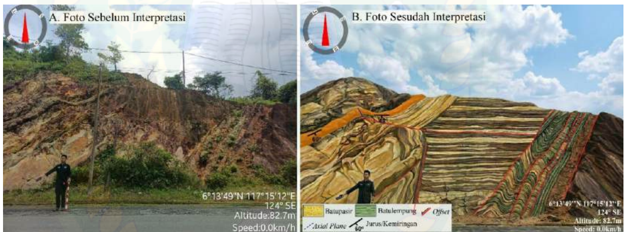
Gambar 4. 21 Foto Singkapan Stasiun 6, (A) Foto Sebelum Interpretasi, (B) Foto Setelah Interpretasi Menunjukkan Adanya Lipatan dan Perlapisan
