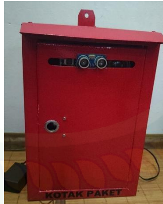
Gambar 4. 1 Tampilan rancang bangun alat keamanan dan pemberitahuan penerima paket pintar menggunakan sensor dfplayer dan kamera berbasis iot
