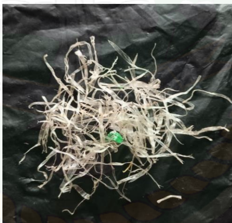
Gambar 4. 16 Bentuk hasil cacahan pada jenis plastik PP di variasi 6 mata pisau
