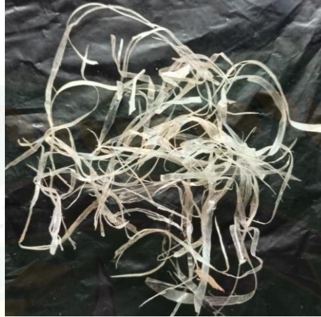
Gambar 4. 12 Bentuk hasil cacahan pada jenis plastik PP di variasi 2 mata pisau
