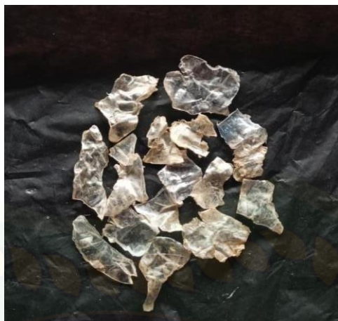
Gambar 4. 15 Bentuk hasil cacahan pada jenis plastik PET di variasi 4 mata pisau
