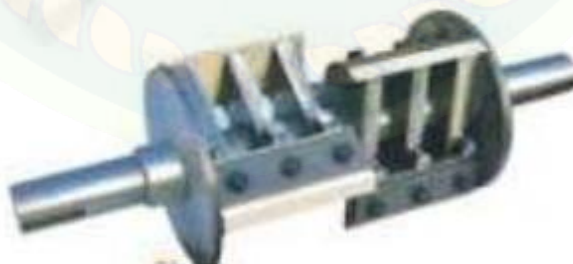
Gambar 2. 18 Susunan Bentuk Mata Pisau Type Flat
