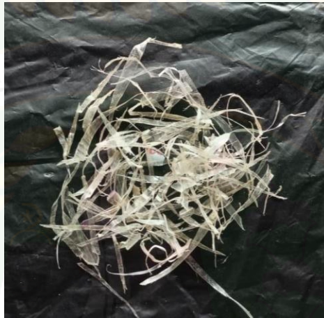
Gambar 4. 14 Bentuk hasil cacahan pada jenis plastik PP di variasi 4 mata pisau
