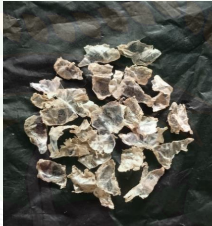
Gambar 4. 17 Bentuk hasil cacahan pada jenis plastik PET di variasi 6 mata pisau
