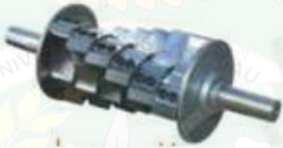
Gambar 2. 17 Susunan Bentuk Mata Pisau Type Claw
