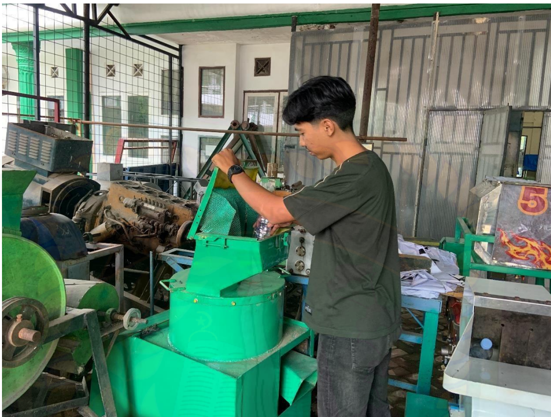
7. Penulis sedang melakukan pengujian mesin pencacah sampah botol plastik
