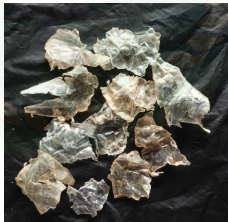
Gambar 4. 13 Bentuk hasil cacahan pada jenis plastik PET di variasi 2 mata pisau
