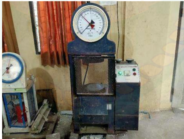
Gambar 3. 12 Mesin Uji Kuat Tekan Beton (Dokumentasi Penelitian, 2025)
