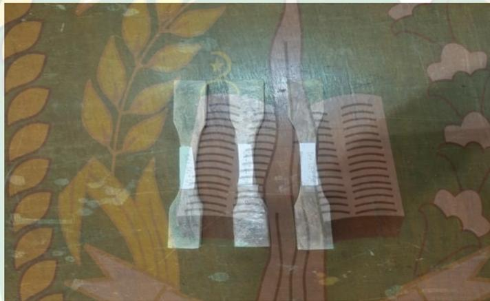
**Gambar 4.2 Spesimen Sebelum Uji Tarik**
