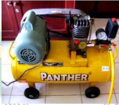
Gambar 2.4 Kompresor dengan *Prime Mover* Motor Listrik
