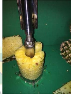
Hasil Pengupasan dengan Sistem Aktuator Pneumatik Dengan Distribusi Udara Bertekanan 4 kgf/cm<sup>2</sup>.
