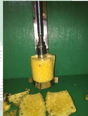
Hasil Pengupasan dengan Sistem Aktuator Pneumatik Dengan Distribusi Udara Bertekanan 5 kgf/cm<sup>2</sup>.
