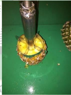
Hasil Pengupasan dengan Sistem Aktuator Pneumatik Dengan Distribusi Udara Bertekanan  $2 \text{ kgf/cm}^2$ .
