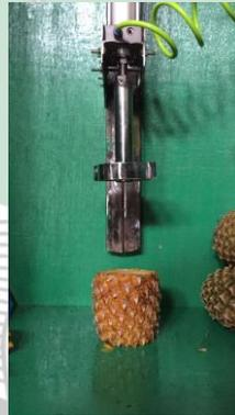
Melakukan pengujian pengupasan dengan sistem aktuator pneumatik
