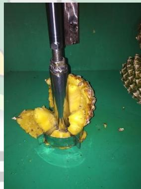
Hasil Pengupasan dengan Sistem Aktuator Pneumatik Dengan Distribusi Udara Bertekanan  $3 \text{ kgf/cm}^2$ .
