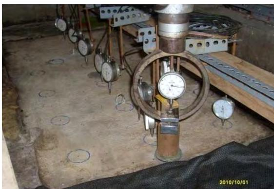
Gambar 3. Foto pengujian beban di ujung pinggir pada pelat terpaku dengan 3 baris tiang
