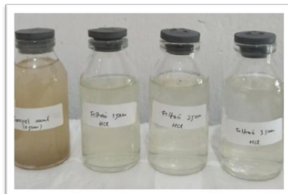
Gambar 7. Peningkatan kejernihan air dengan variasi waktu kontak.
