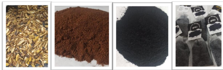
Gambar 1. Proses Preparasi Kulit pisang menjadi BPAC (Banana Peels Activated Carbon).
