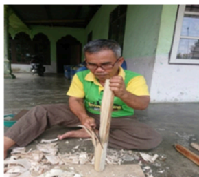
Gambar 15: Proses Pembentukan Kayu Menjadi Bilah-bilah Gambang (Dokumentasi Penulis, 2021)
