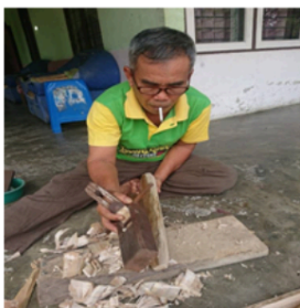
Gambar 20: Proses Pengetaman Permukaan Kayu (Dokumentasi Penulis, 2021)
