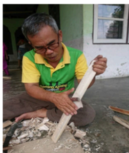
Gambar 23: Proses Penghalusan Permukaan Kayu (Finishing) (Dokumentasi Penulis, 2021)
