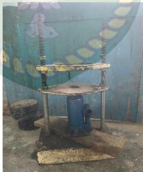
**Gambar 4. 28** Alat Pengeluar Benda Uji atau Extruder (Dokumentasi Peneliti,2024)
