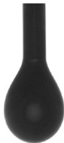
Gambar 6a. Oil droplet pada tekanan 700 psia dan temperatur 60°C.
