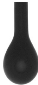
Gambar 6b. Oil droplet pada tekanan 1000 psia dan temperatur 60°C.
