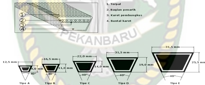
Gambar 2.4 Konstruksi dan ukuran penampang sabuk-V
