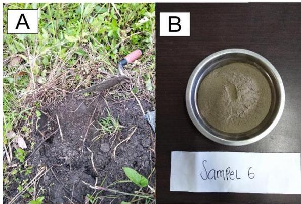
Gambar 7. Sampel tanah di Jl. Kaharuddin Nasution; A. sampel dilapangan; B. Sampel setelah analisis granulometri
