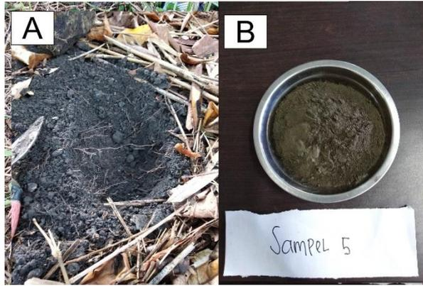
Gambar 6. Sampel tanah di Jl. Sudirman; A. sampel dilapangan; B. Sampel setelah analisis granulometri
