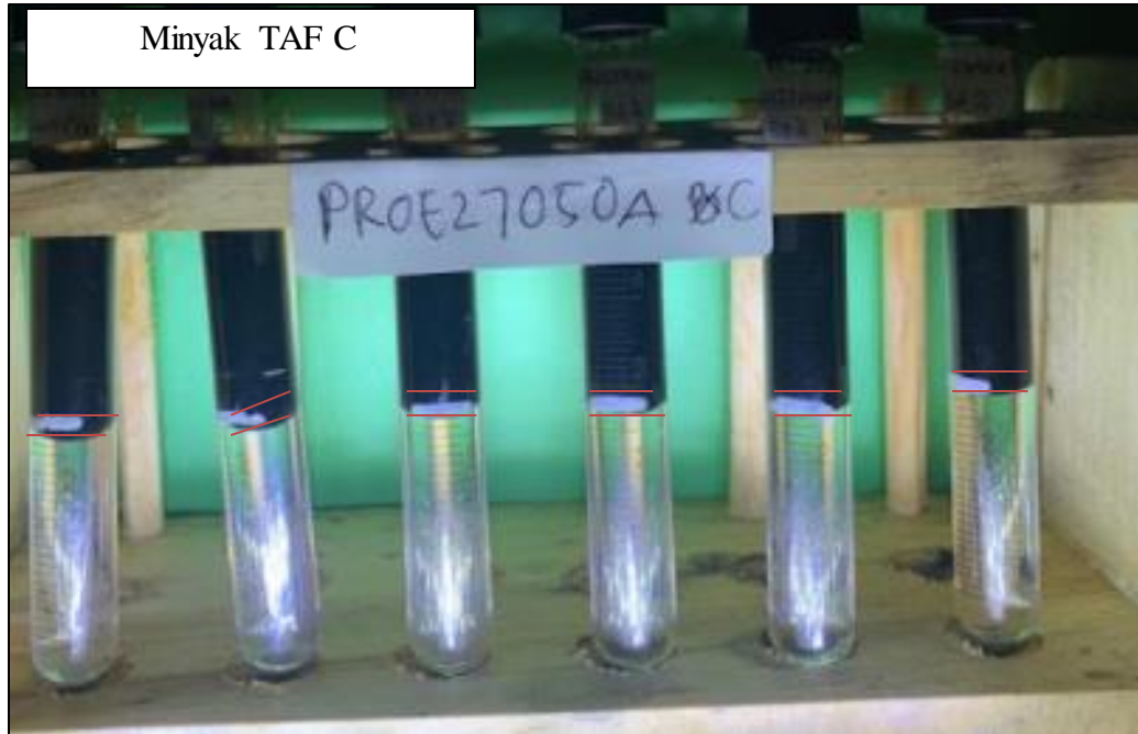
Gambar 17. Hasil Pengujian Phase Behaviour Setelah Pengamatan Selama 7 Hari pada Konsentrasi Surfaktan 0,075% ; 0,15% ; 0,3% ; 0,6% ; 0,9% dan 1,2% Salinitas Sintetic Water 20.000 ppm
