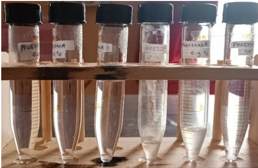
Gambar 12. Hasil Pengujian Compatibility Test pada Konsentrasi Surfaktan 0,075% ; 0,15% ; 0,3%, 0,6%, 0,9% dan 1,2% dengan Salinitas Sintetic Water 20.000 ppm dan Suhu Pengujian 104 °C
