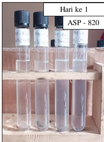
Gambar 3. Hasil Pengujian Compatibility Test Polimer ASP – 820 pada Konsentrasi 0,05%; 0,01%; 0,15% dan 0,2% dengan Salinitas Air Formasi: 20.000 ppm. Suhu Pengujian 104 °C
