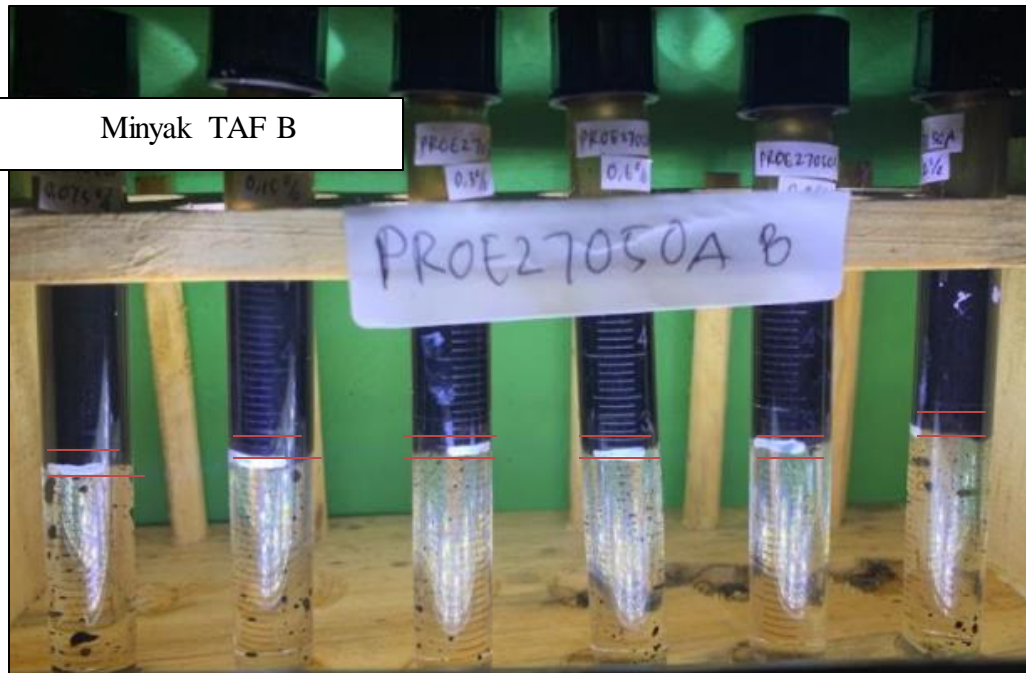
Gambar 18. Hasil Pengujian Phase Behaviour Setelah Pengamatan Selama 7 Hari pada Konsentrasi Surfaktan 0,075% ; 0,15% ; 0,3% ; 0,6% ; 0,9% dan 1,2% Salinitas Sintetic Water 20.000 ppm
