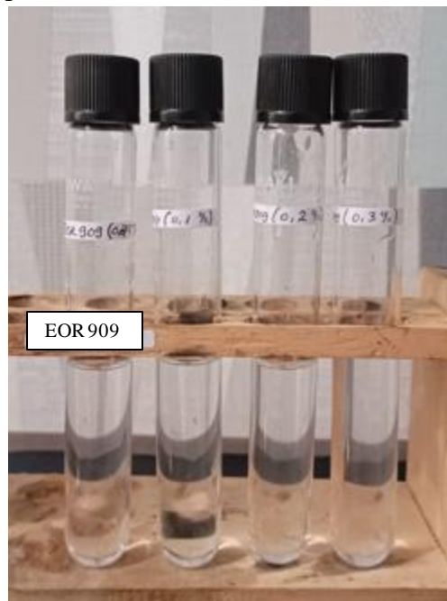
Gambar 5. Hasil Pengujian Compatibility Test Polimer EOR 909 pada Konsentrasi 0,75% ; 0,1% ; 0,2% dan 0,3% dengan Salinitas Sintetic Water 20.000 ppm. Suhu Pengujian 104 °C
