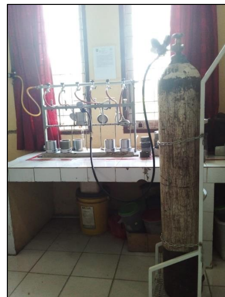
Rangkaian Alat Uji Filtration Test
