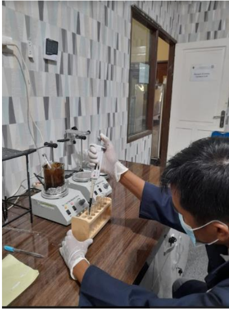
Memasukkan minyak ke dalam tube test (WOR 1:1)
