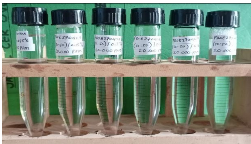
Gambar 13. Hasil Pengujian Compatibility Test pada Konsentrasi Surfaktan 0,075% ; 0,15% ; 0,3%, 0,6%, 0,9% dan 1,2% dengan Salinitas Sintetic Water 20.000 ppm dan Suhu Pengujian 104 °C
