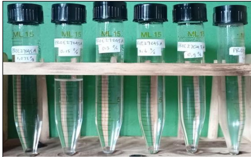
Gambar 9. Hasil Pengujian Compatibility Test pada Konsentrasi Surfaktan 0,075% ; 0,15% ; 0,3%, 0,6%, 0,9% dan 1,2% dengan Salinitas Sintetic Water 20.000 ppm dan Suhu Pengujian 104 °C
