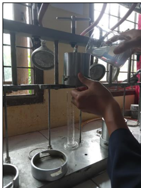
Memasukkan Larutan Surfaktan pada Silinder Alat Filtrasi
