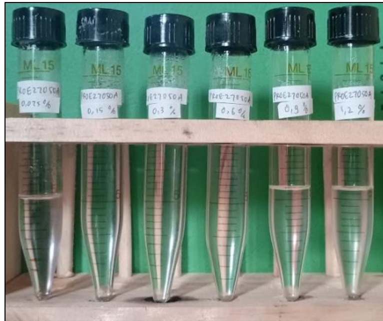
Gambar 10. Hasil Pengujian Compatibility Test pada Konsentrasi Surfaktan 0,075% ; 0,15% ; 0,3%, 0,6%, 0,9% dan 1,2% dengan Salinitas Sintetic Water 20.000 ppm dan Suhu Pengujian 104 °C
