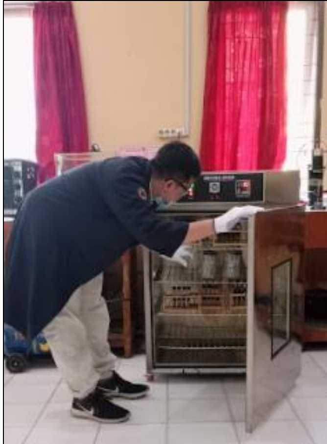
Sampel dimasukkan di dalam oven untuk diuji pada suhu reservoir
