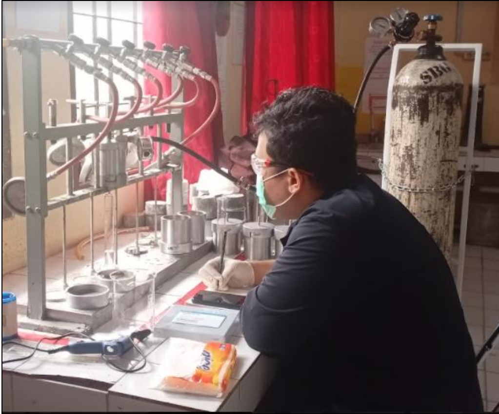
Pencatatan Waktu Setiap 10 ml Larutan Surfaktan yang Keluar dari Silinder Alat Filtrasi
