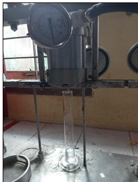
Menutup Silinder Alat Filtrasi yang Terhubung dengan Gas N_2 yang dialiri pada Tekanan 30 psi
