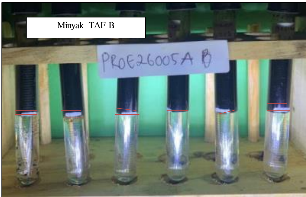
Gambar 20. Hasil Pengujian Phase Behaviour Setelah Pengamatan Selama 7 Hari pada Konsentrasi Surfaktan 0,075% ; 0,15% ; 0,3% ; 0,6% ; 0,9% dan 1,2% Salinitas Sintetic Water 20.000 ppm
