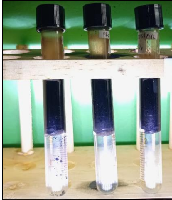
Gambar 26. Hasil Pengujian Phase Behaviour Setelah Pengamatan Selama 7 Hari pada Konsentrasi Surfaktan 0,075% ; 0,6% dan 1,2% Salinitas Sintetic Water 20.000 ppm
