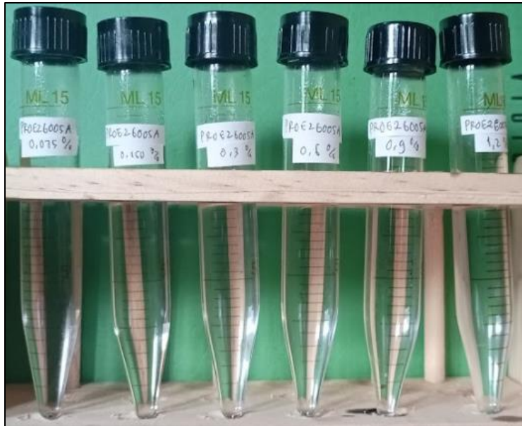
Gambar 11. Hasil Pengujian Compatibility Test pada Konsentrasi Surfaktan 0,075% ; 0,15% ; 0,3%, 0,6%, 0,9% dan 1,2% dengan Salinitas Sintetic Water 20.000 ppm dan Suhu Pengujian 104 °C
