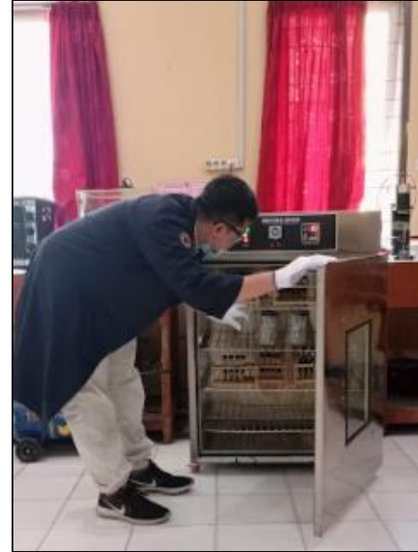
Memasukkan sampel uji ke dalam oven \pm 30 menit untuk mencairkan minyak
