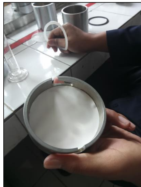
Meletakkan Ring Karet Sebagai Seal pada Silinder Alat Filtrasi
