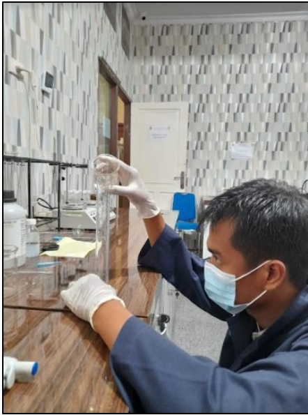
Mengukur jumlah air formasi untuk pembuatan larutan
