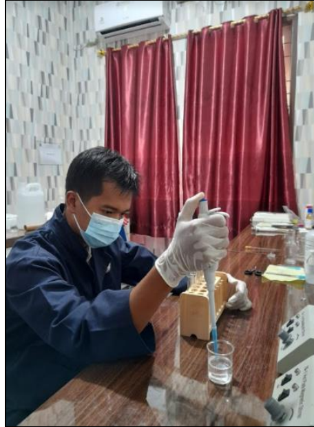
Memasukkan larutan surfaktan ke dalam tube test (WOR 1:1)
