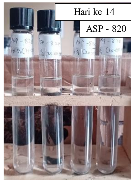
Gambar 3. Hasil Pengujian Compatibility Test Polimer ASP – 820 pada Konsentrasi 0,05%; 0,01%; 0,15% dan 0,2% dengan Salinitas Air Formasi: 20.000 ppm. Suhu Pengujian 104 °C
