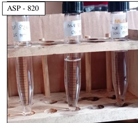
Gambar 2. Hasil Pengujian Compatibility Test Polimer ASP - 820 pada Konsentrasi 0,0025%; 0,005% dan 0,01% dengan Salinitas Air Formasi: 20.000 ppm. Suhu Pengujian 104 °C
