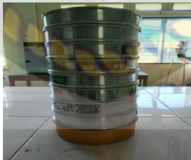
Gambar 4.1 Alat Pengujian Analisa Saringan
