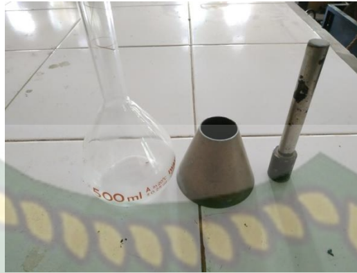
Gambar 4.3 Alat Pengujian Berat Jenis Agregat Halus
