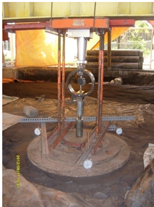
Gambar 4.5 Pelaksanaan uji beban pelat standar pada lempung lunak.
